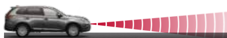
ZONDER VOORLIJGER De ingestelde snelheid blijft gehandhaafd, zonder dat de bestuurder het gaspedaal bedient.
