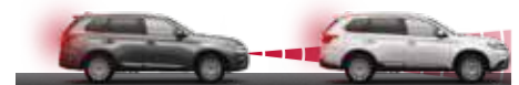
VOORLIJGER DIE LANGZAMER RIJDT OF STOPT Wanneer het voertuig voor u langzamer gaat rijden of stopt, zal ACC uw auto langzamer laten rijden of volledig tot stilstand brengen.
